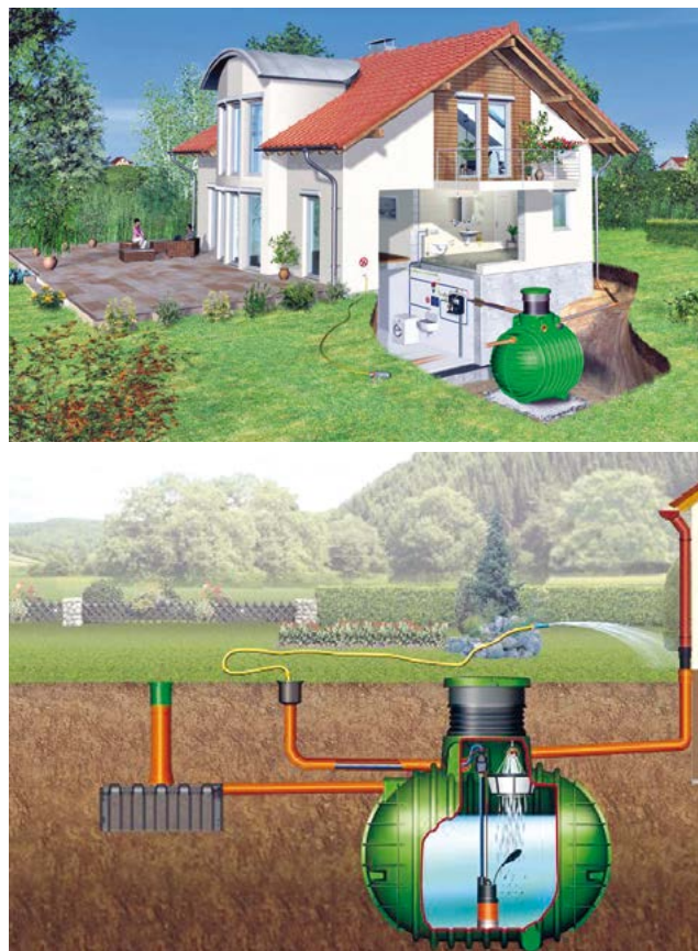
Obr. 31: Príklady využitia podzemnej nádrže v domácnosti alebo na záhrade
